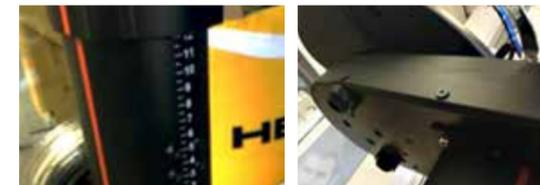
Höhenverstellbar mit Skala    Nivellierpads auf Tischplatte
